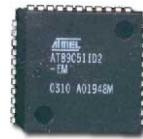
Slika 2.12. 8 - bitni mikrokontroler AT89C51ID2
