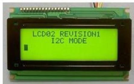
Slika 2.9. LCD ekran na robotu [11]
