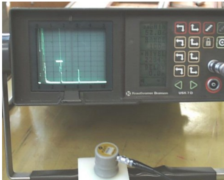
Slika 6. Ultrazvučni uređaj sa pripadnom sondom [1]
