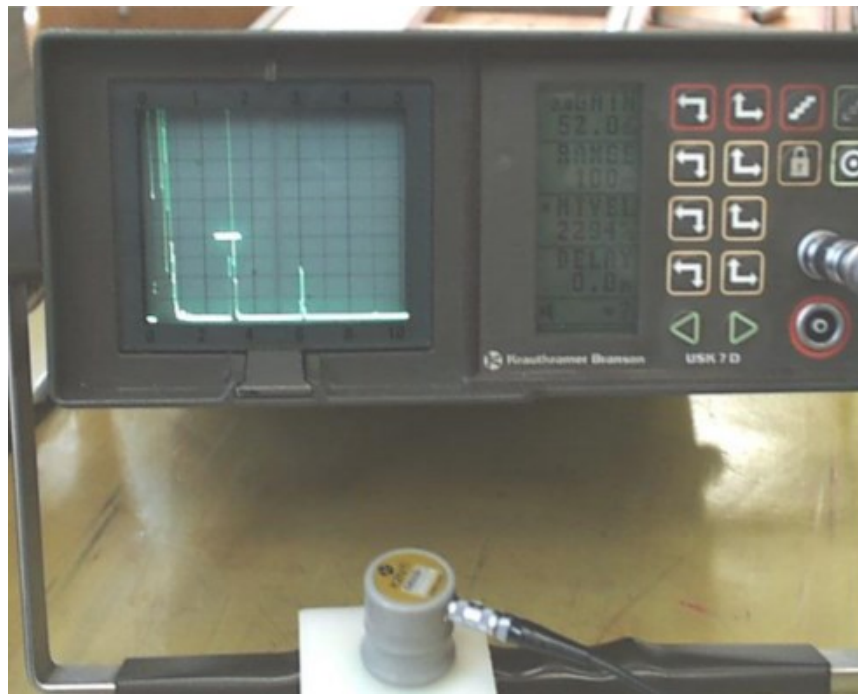
Slika 6. Ultrazvučni uređaj sa pripadnom sondom [1]
