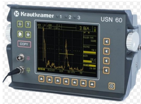
Slika 15. Ultrazvučni uređaj Krautkramer USN60 [7]
