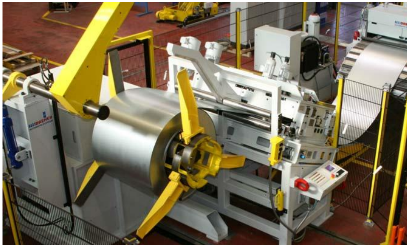
Slika 8. - Stroj za namatanje lima na bubanj [6]
