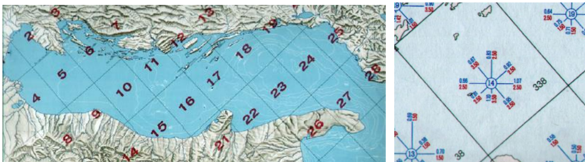
Slika 3-1 Podjela Jadrana po zonama ( 1^\circ \times 1^\circ ) prema Atlasu valova – HHI (lijevo) i primjer ruže valova (desno)
