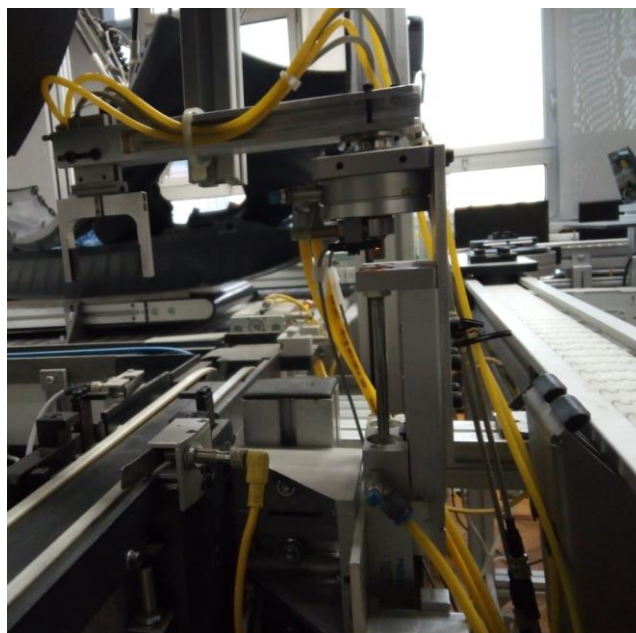
Slika 1. Dvo-osni manipulator u prirodnom okruženju
