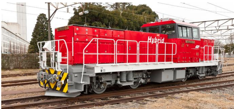
Slika 2.3 Hibridna lokomotiva Toshiba Class HD300 [3]
