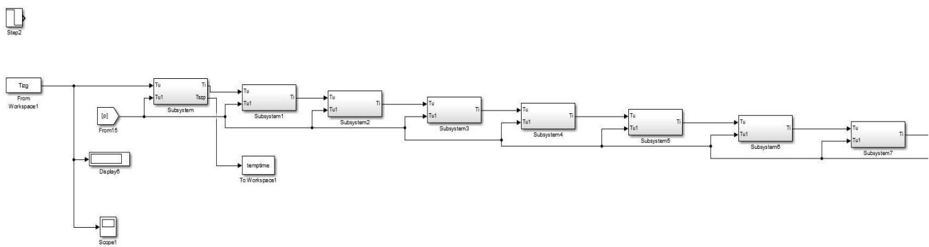
**Slika 19.** Simulink shema isparivača podjeljen na 15 segmenata
