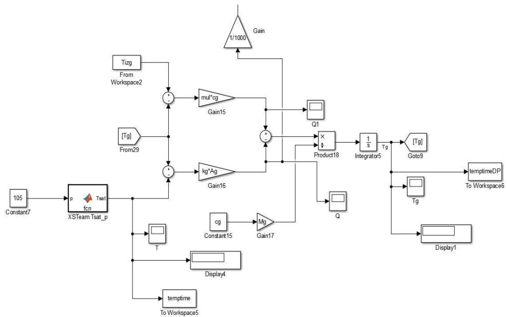
**Slika 21.** Simulink shema izvedbe dimnih plinova u ložištu
