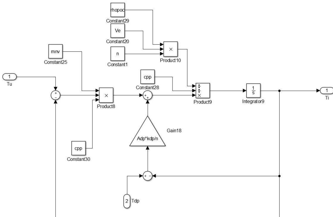
Slika 17. Shema korištenih block-ova u simulinku za vodenji trakt ekonomjazera
