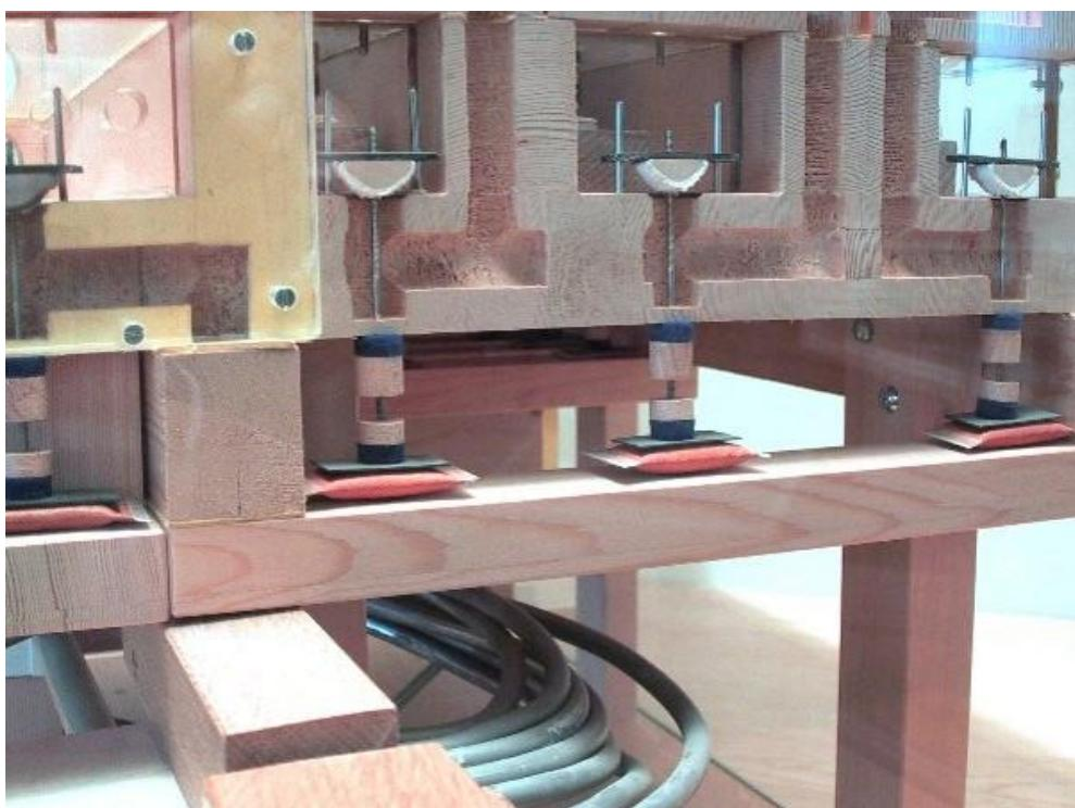
**Slika 15. Prikaz pneumatske zračnice s čunjastim ventilima u presjeku**
