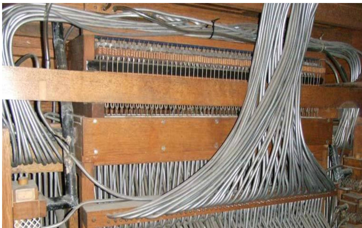
Slika 11. Izgled pneumatskog sustava prijenosa kod orgulja
