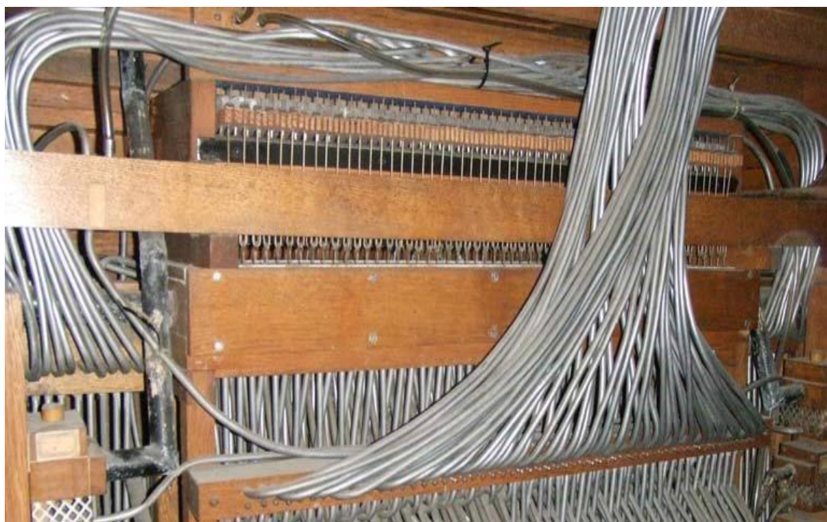
Slika 11. Izgled pneumatskog sustava prijenosa kod orgulja
