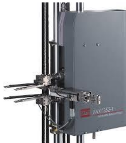
Slika 10: Automatski kontaktni ekstenzometar [7]
