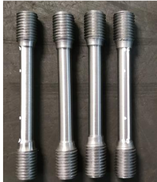
Slika 18: Skraćena duljina "glave" epruvete
