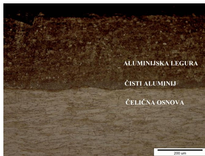
Slika 31. Raspored slojeva na primjeru uzorka 2
