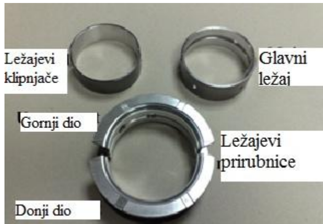
Slika 20. Tipovi i glavni dijelovi ležaja [11]
