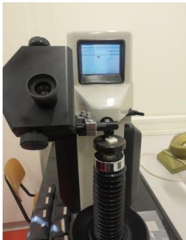
*Slika 27. Indentec uređaj za mjerjenje tvrdoće s uzorakom  $\text{Al}_2\text{O}_3$  keramike*
