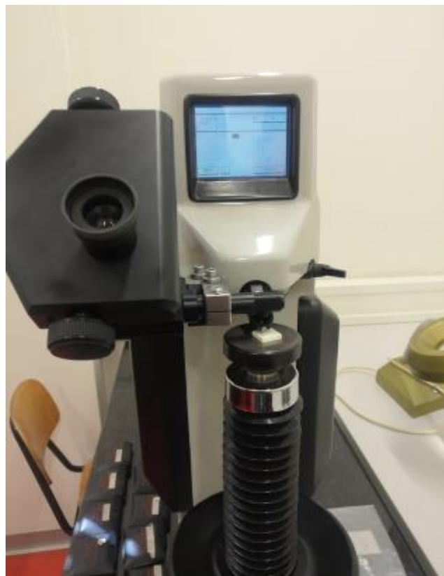
Slika 27. Indentec uređaj za mjerenje tvrdoće s uzorakom Al_2O_3 keramike
