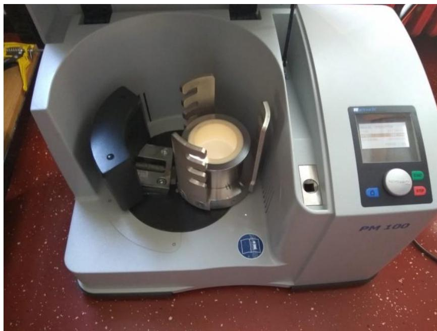
Slika 18. Planetarni kuglični mlin Retsch PM 100
