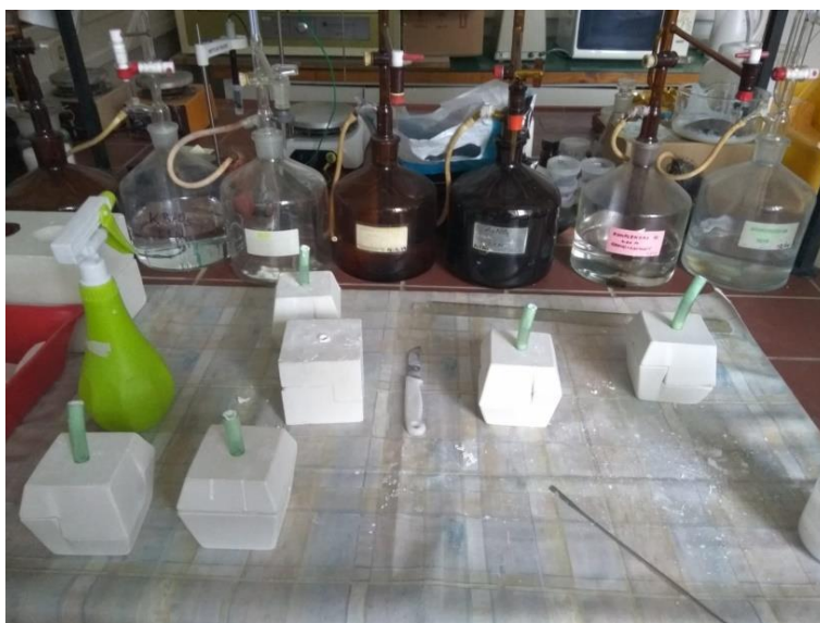
Slika 22. Gipsani kalupi napravljeni za lijevanje suspenzija
