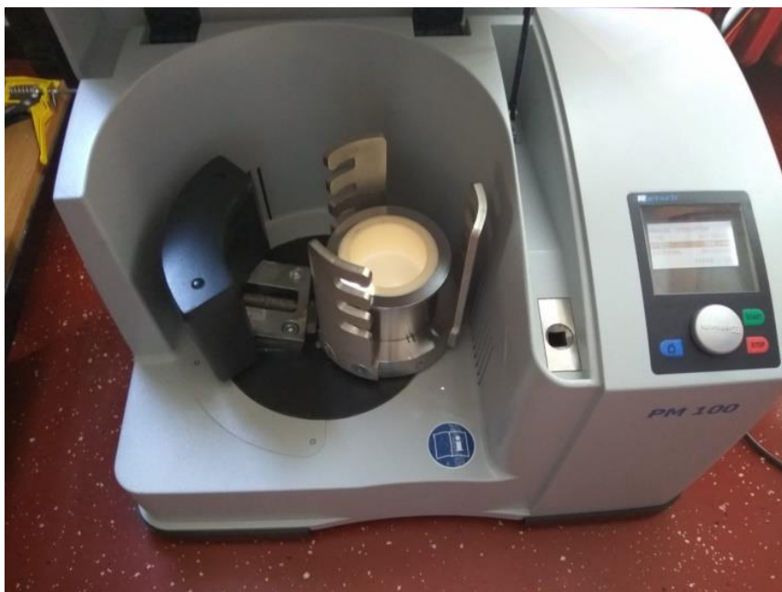
Slika 18. Planetarni kuglični mlin Retsch PM 100
