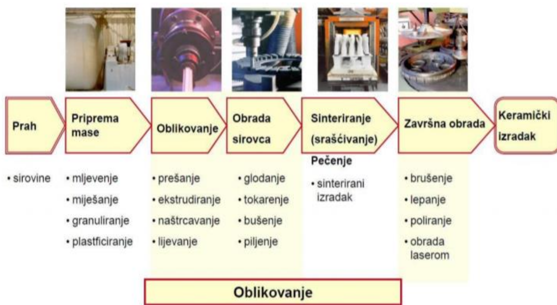
Slika 7. Proces proizvodnje keramike [16]
