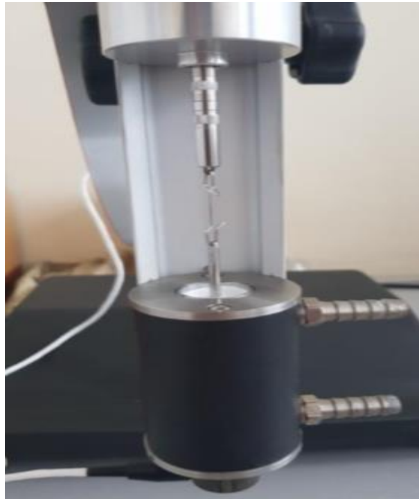
Slika 20. Cilindar sa suspenzijom i vretenom
