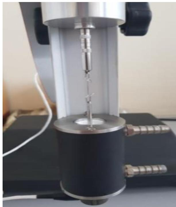
Slika 20. Cilindar sa suspenzijom i vretenom
