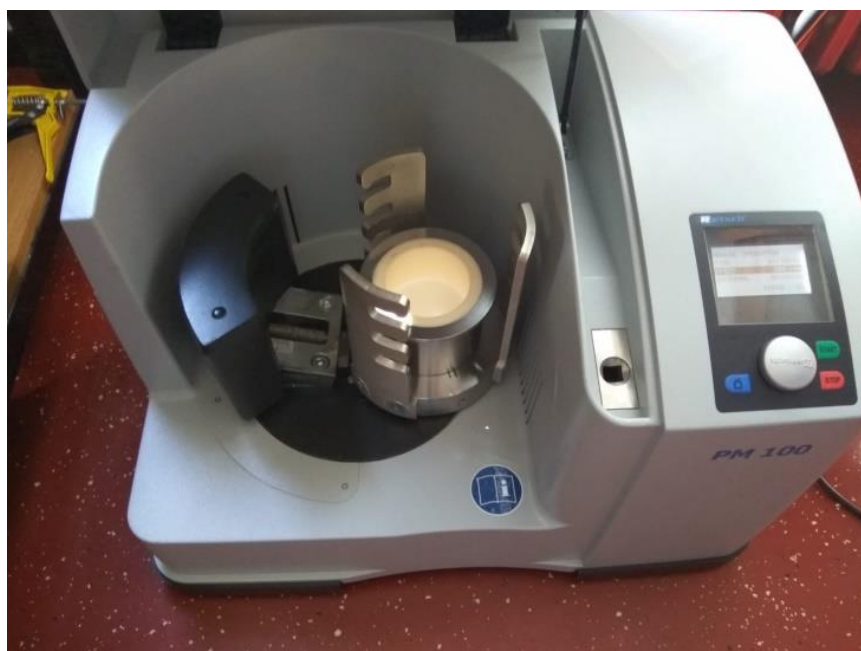
Slika 18. Planetarni kuglični mlin Retsch PM 100
