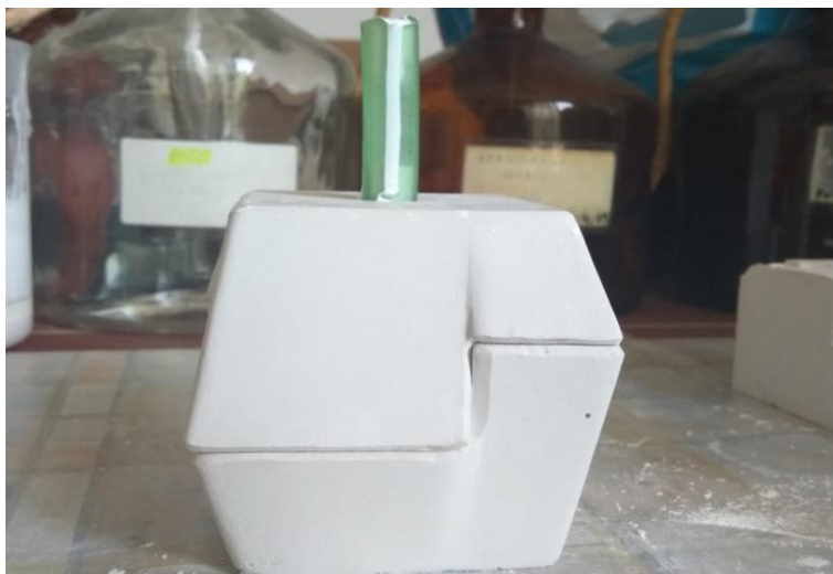
Slika 21. Gipsani kalup s ulivenom suspenzijom
