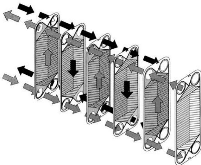
Slika 12 Prikaz strujanja fluida kroz pločasti isparivač [11]
