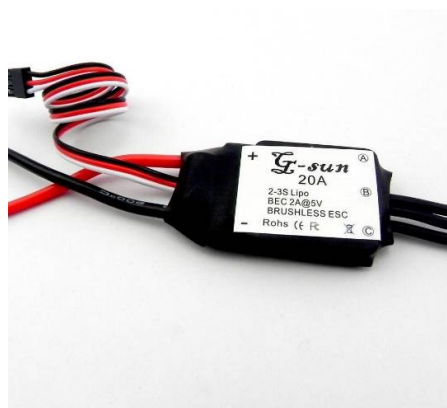
Slika 8.4. Kontroler za motore
