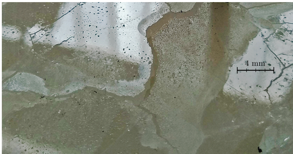
Slika 3.16: Površina natrijevog nitrata, uz staklo, nakon solidifikacije
