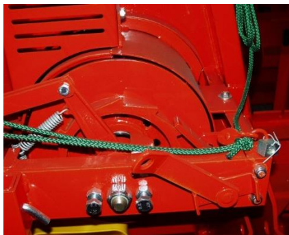
Slika 16. Mehanizam spojke i zadrživača
