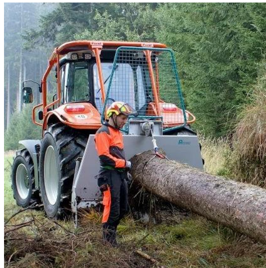
Slika 1. Prikaz traktorskog vitla u radu
