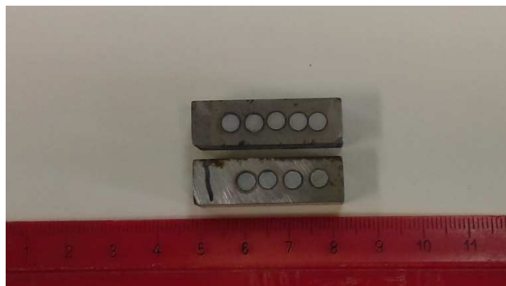
Slika 60. Mjerna mjesta određivanja kemijskog sastava na API 5L X80
