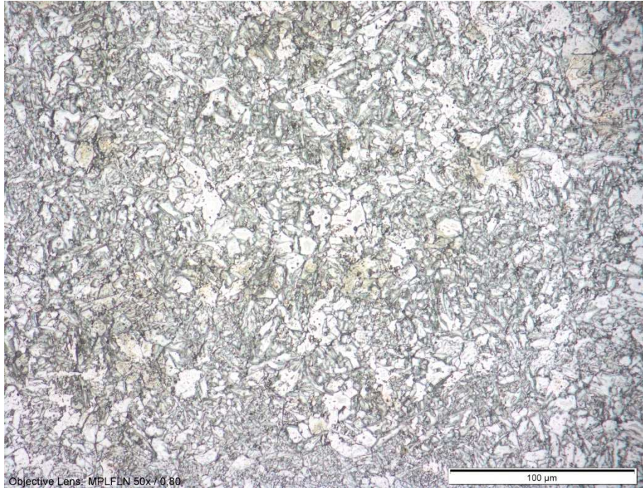
Slika P.VI-1. Mikrostruktura metala zavara, ploča 2D. Svjetlosni mikroskop
