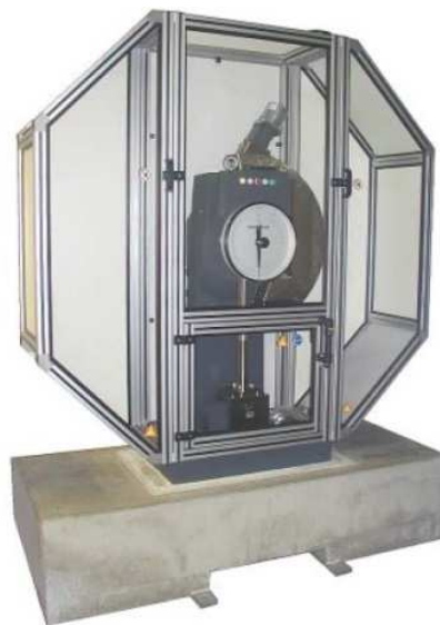
Slika 7. Suvremeni instrumentirani Charpy uređaj [40]
