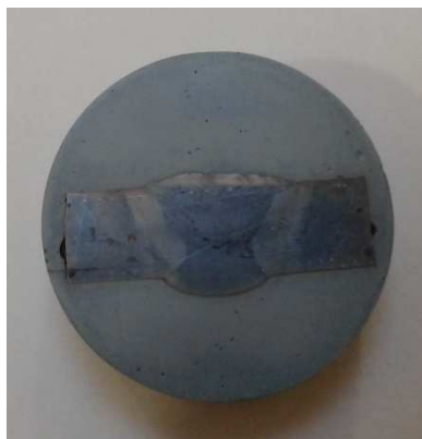
Slika 73. Izbrusak zavarenog spoja pripremljen za mjerenje tvrdoće
