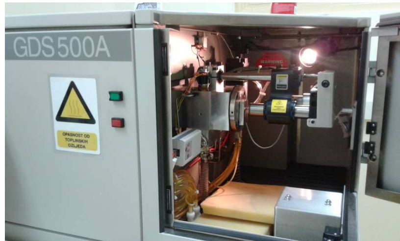
Slika 59. Uređaj za ispitivanje kemijskih svojstava, model GDS 500A
