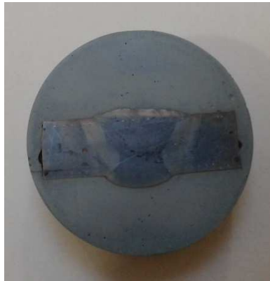
Slika 73. Izbrusak zavarenog spoja pripremljen za mjerenje tvrdoće
