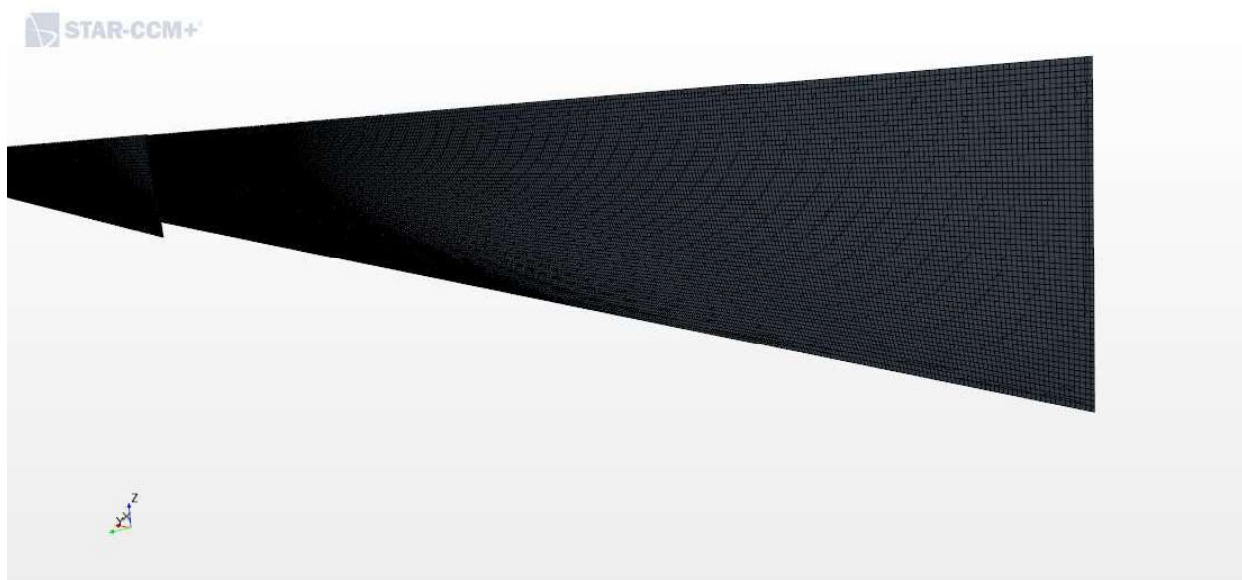
Slika 13. Diskretizacija trimaranske konfiguracije k1 (fina mreža)
