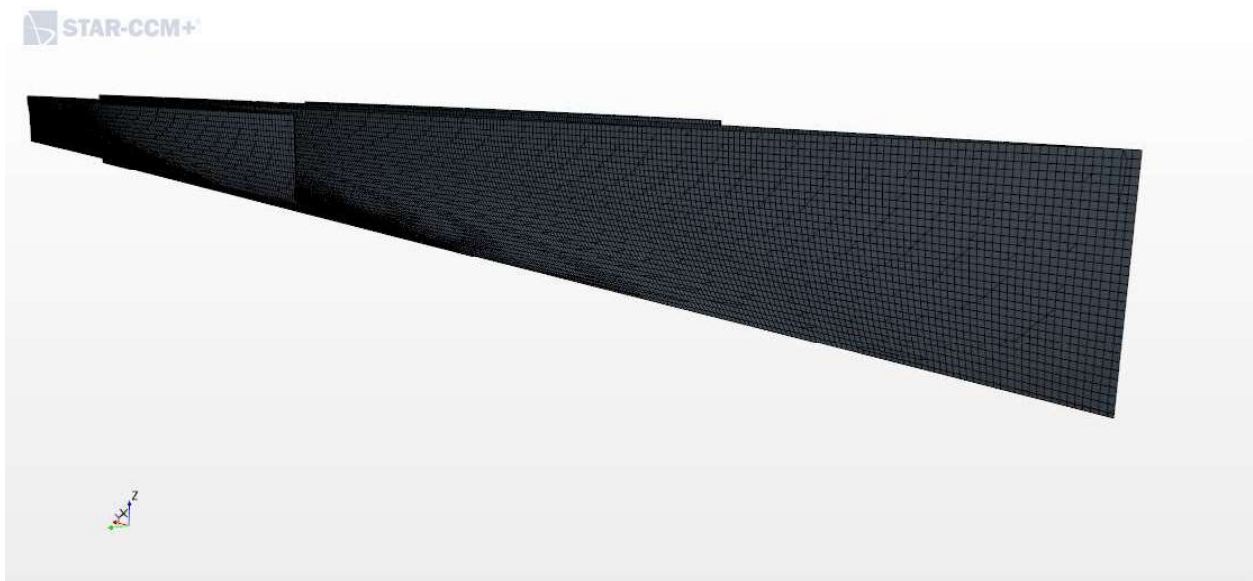
Slika 12. Diskretizacija trimaranske konfiguracije k1 (gruba mreža)
