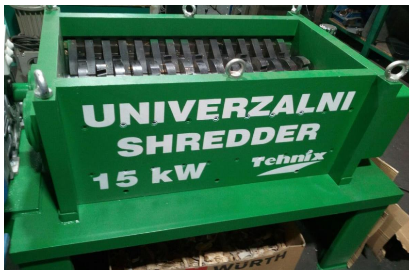
Slika 13. Shredder za RDF kapaciteta 10 t/h
