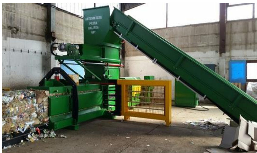
Slika 12. Automatska preša balirka [1]
