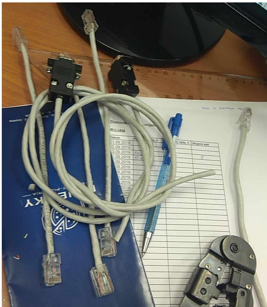
Slika 60. Komunikacijski kabeli za Ethernet i RS422
