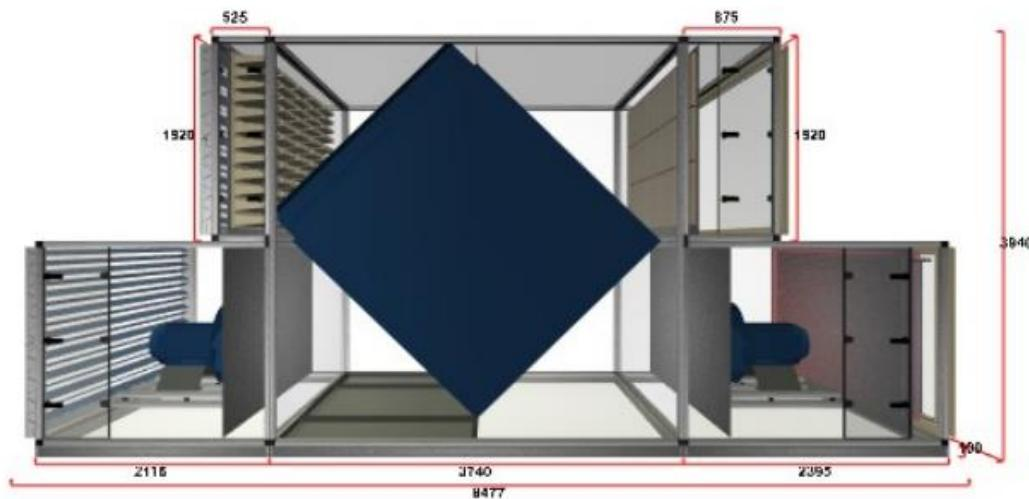
**Slika 12 – Centralna jedinica za pripremu zraka DAIKIN D-AHU PROFESSIONAL**
