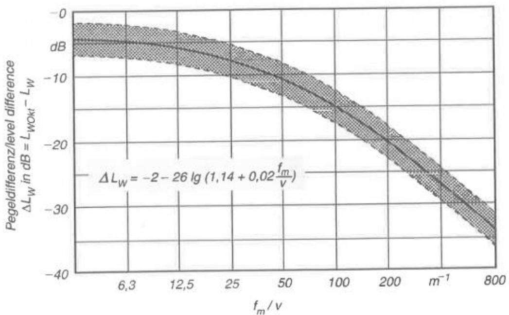
**Slika 14 – Dijagram raščlanjivanja ukupne zvučne snage po frekvencijama**
