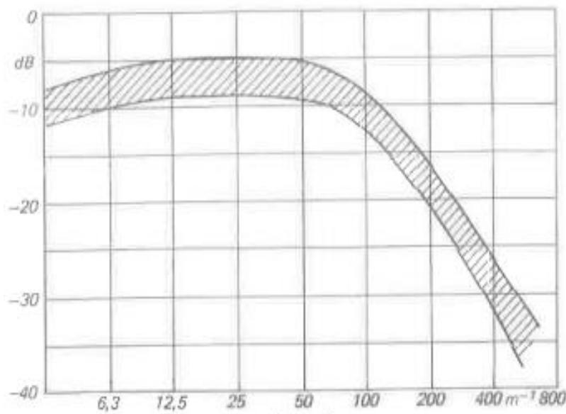
Rešetka vrste OAB Klimaopreme za zadani protok ima razinu zvučne snage 30 dB(A). Nakon provedenog postupka prema frekvencijama i poništavanja korekcije filtera A dobiven je sljedeći rezultat.
