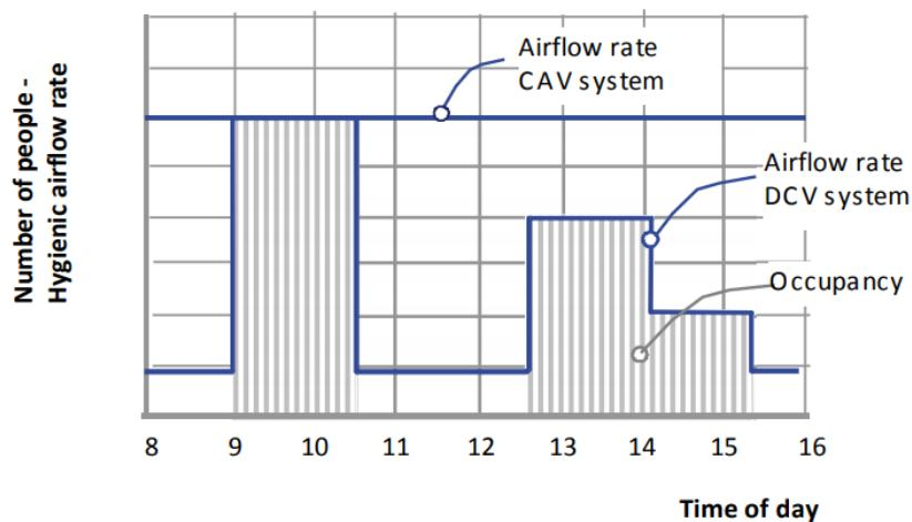
Slika 1 – Usporedba rada CAV i DCV sustava
