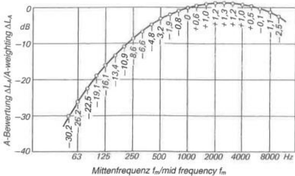
**Slika 13 – Dijagram korekcije filtera A zvučne snage**
