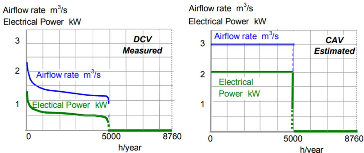
Slika 2 – Usporedba potrošnje energije CAV i DCV sustava
