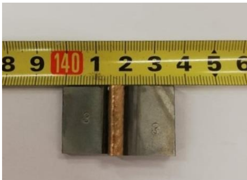
Slika 37 Naličje zavara uzorka 1
