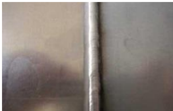
Slika 14 Spoj pocinčanog lima i aluminija, oba debljine 1mm. Brzina zavarivanja 70cm/min [1]
