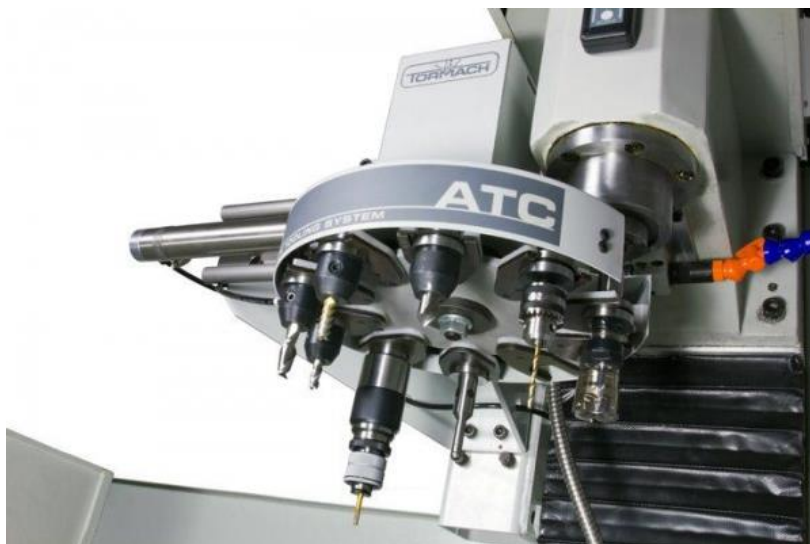
Slika 8. Nosač alata s automatskom izmjenom
