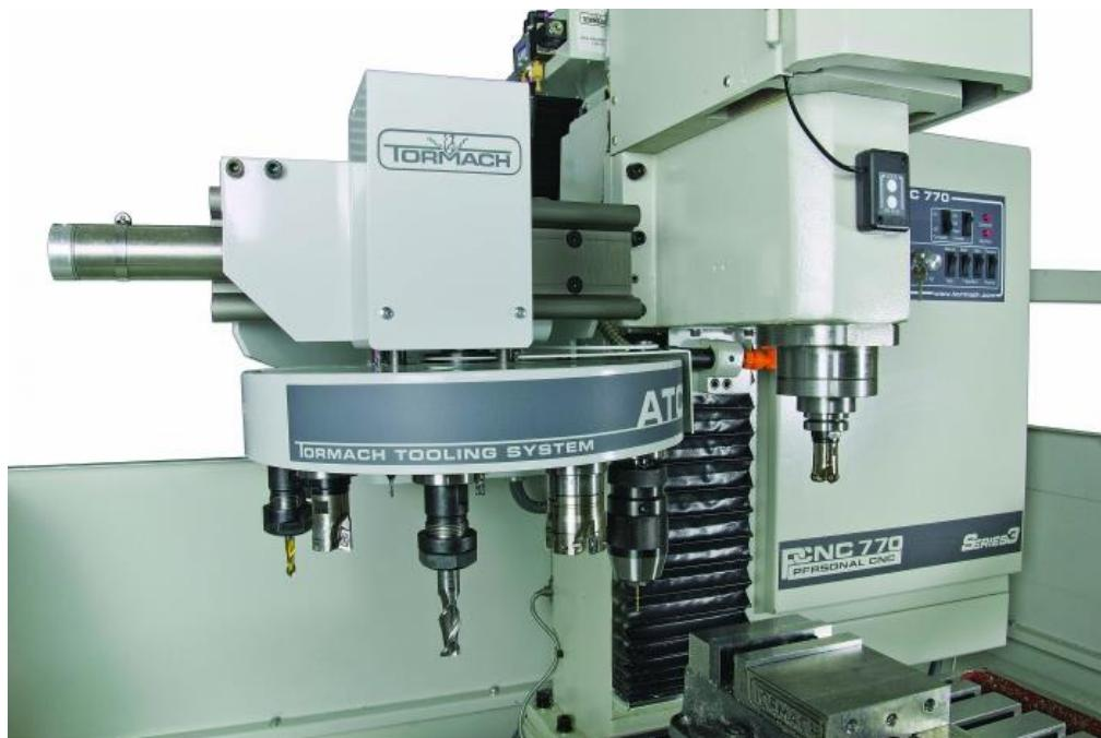
Slika 15. Kružni magazin i CNC stroj
