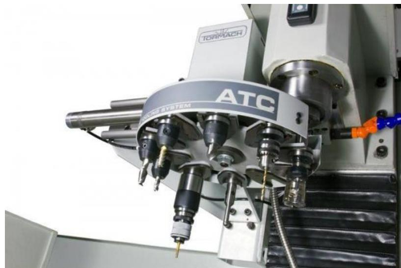
Slika 8. Nosač alata s automatskom izmjenom
