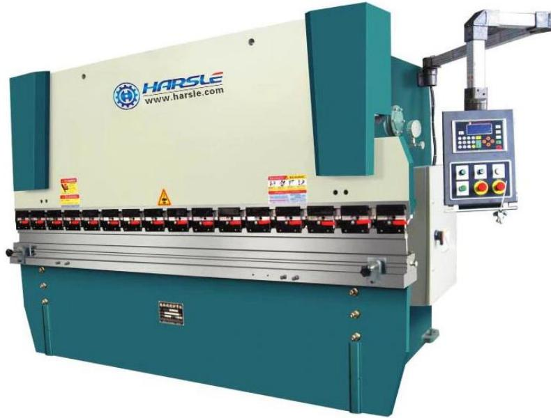
**Slika 2.3. Hidraulička savijačica**
