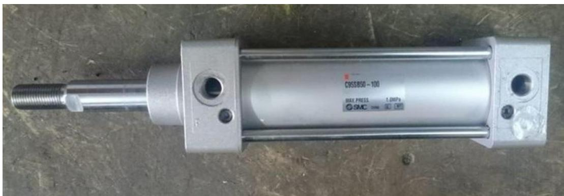
**Slika 2.8. Aktuator C95SB50 – 100**
