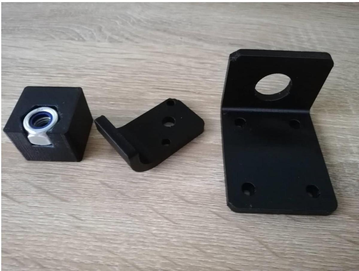
**Slika 2.6. Dijelovi izrađeni aditivnom tehnologijom 3D ispisa**
