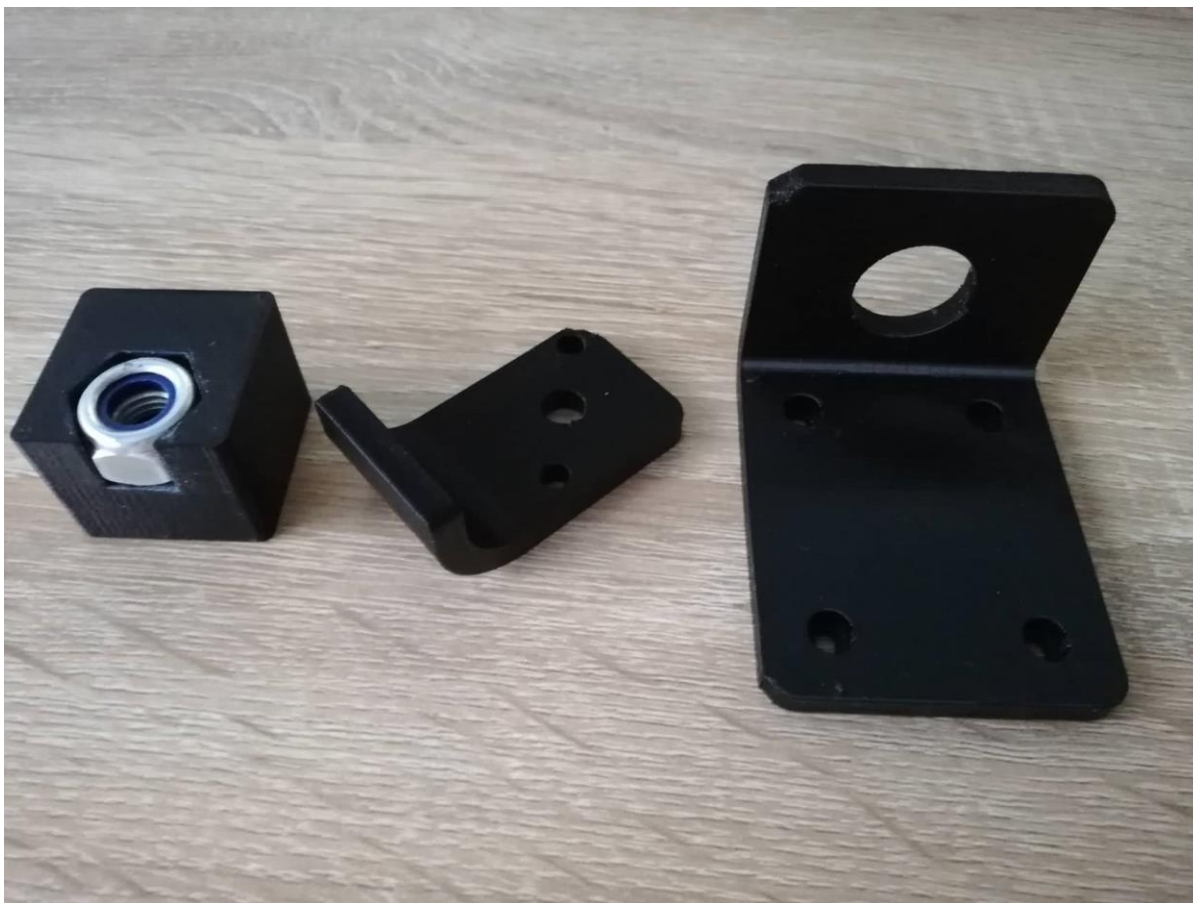
Slika 2.6. Dijelovi izrađeni aditivnom tehnologijom 3D ispisa
