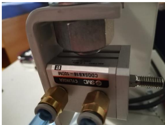
Slika 2.9. Aktuator CDQSKB16 – 10DM
