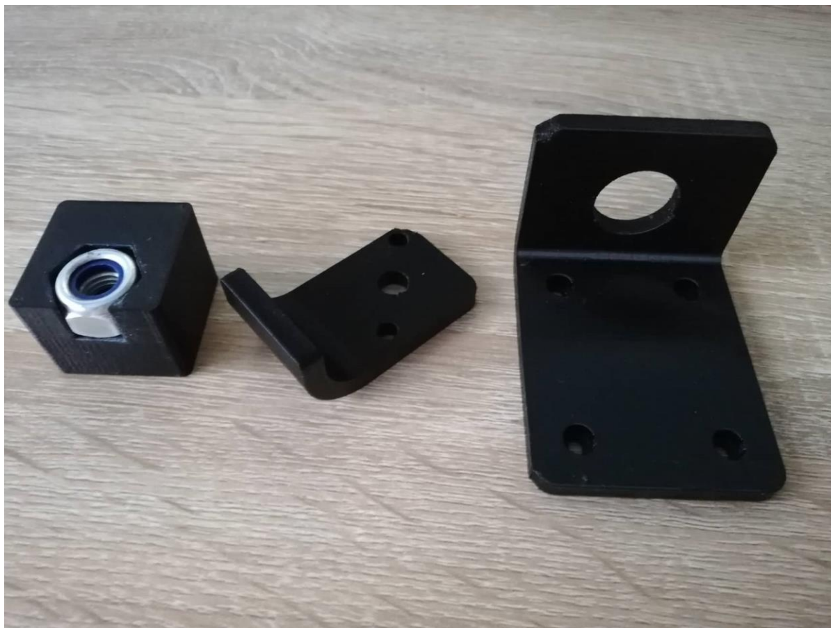
Slika 2.6. Dijelovi izrađeni aditivnom tehnologijom 3D ispisa
