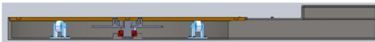
Slika 15. Presjek sklopa postolja
