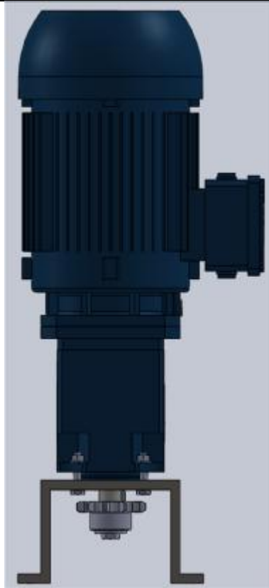
Slika 17. Pogon rotacijskog stola
