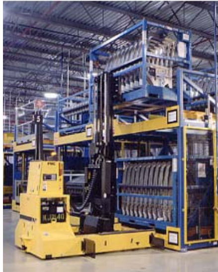
Slika 37. Upotreba AGV-a za skladištenje rezervnih dijelova
