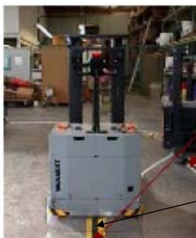
Slika 11. Indukcijski vođeno vozilo
