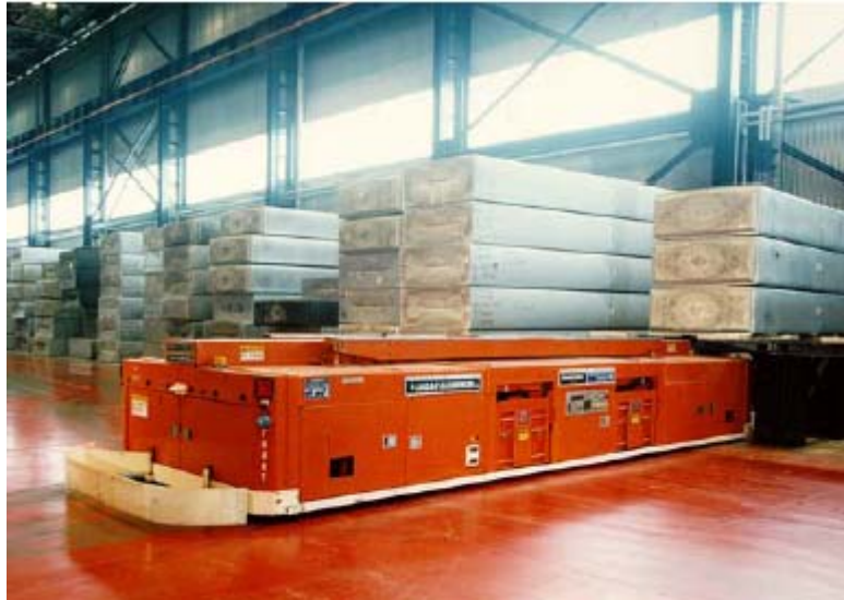
Slika 35. AGV vozilo za prijevoz tereta do 120 tona
