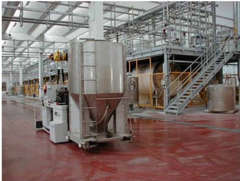
Slika 29. AGV vozilo u kemijskoj industriji
