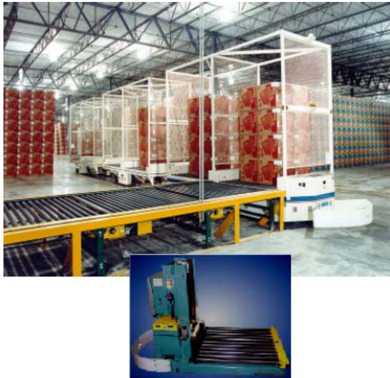
Slika 25. Primjer vozila s valjkastim konvejerom
