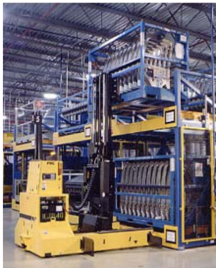
Slika 37. Upotreba AGV-a za skladištenje rezervnih dijelova
