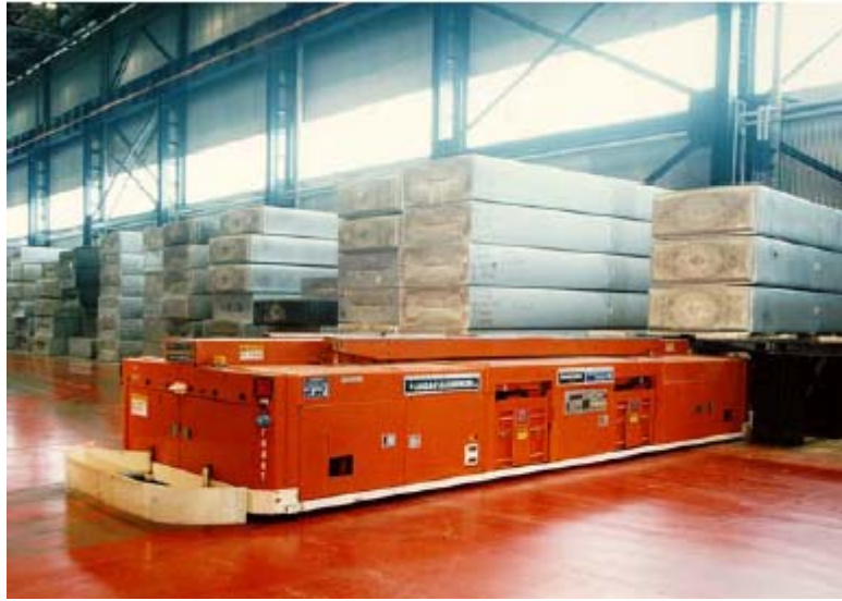
Slika 35. AGV vozilo za prijevoz tereta do 120 tona
