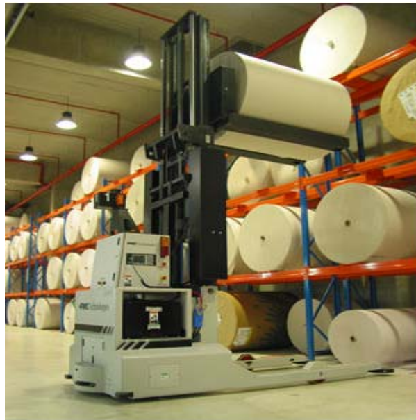
Slika 38. AGV u skladištu papira
