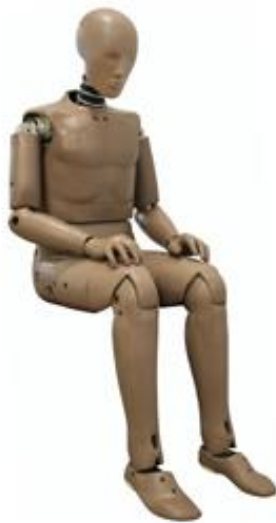
Slika 6. Hybrid III "crash" test lutka [13]
