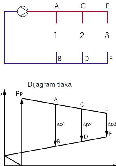
Slika 1.1. Razdioba tlaka u jednostavnom dvocijevnom sustavu
