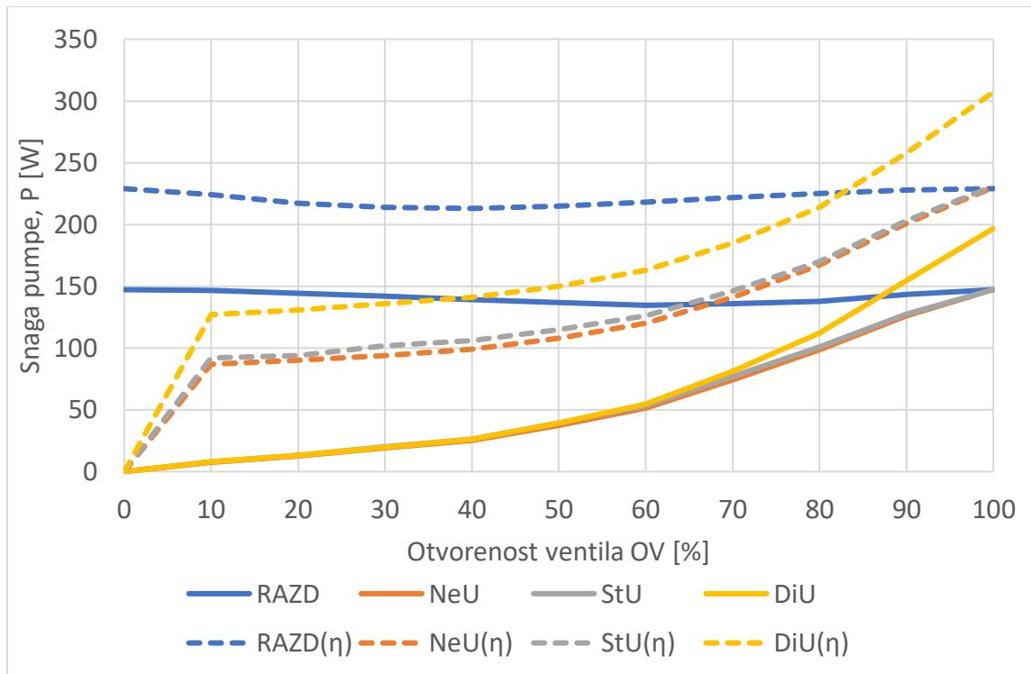
**Slika 6.3. Snage pumpa sustava pri različitim otvorenostima ventila**
