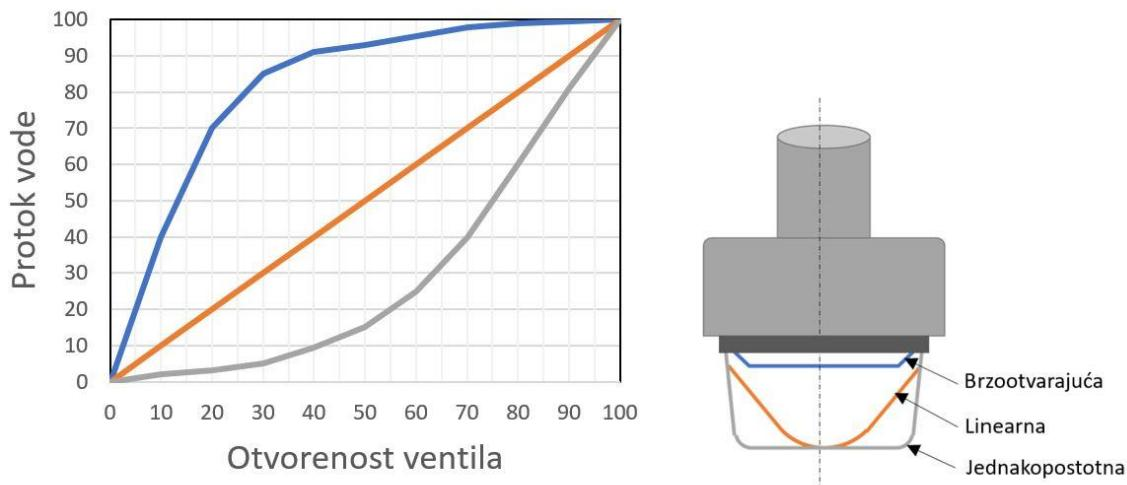
Slika 2.5. Vlastite karakteristike ventila i oblici pladnja
