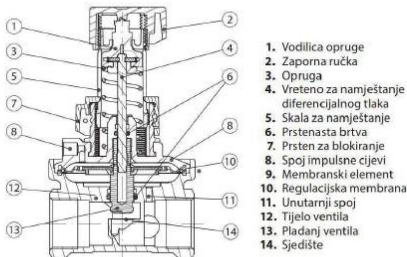
**Slika 2.14. Presjek glavnog (regulacijskog) automatskog balans ventila**
