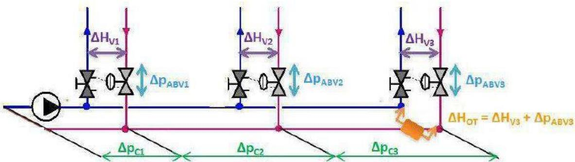
**Slika 3.9. Shema jednostavnog sustava grijanja s vertikalama**
