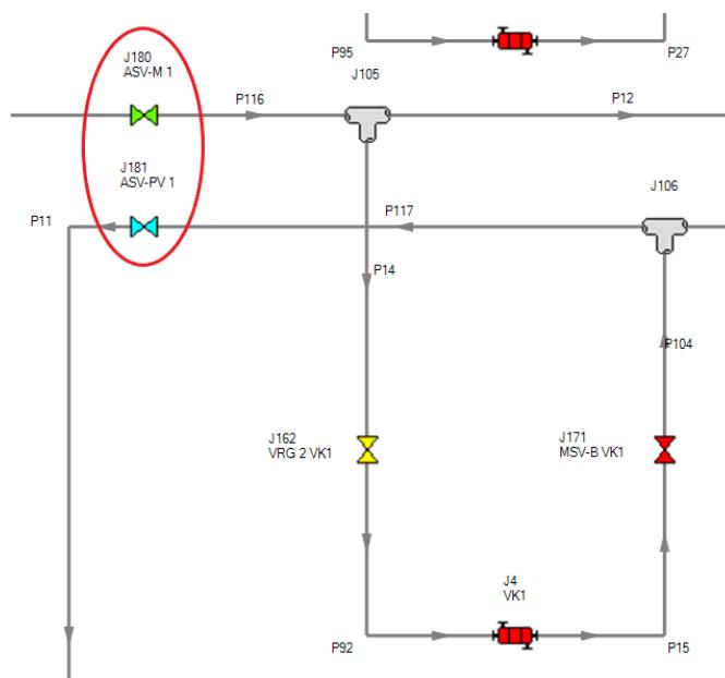
**Slika 5.11. Shema s prigušivanjem za dinamički uravnotežen sustav**
