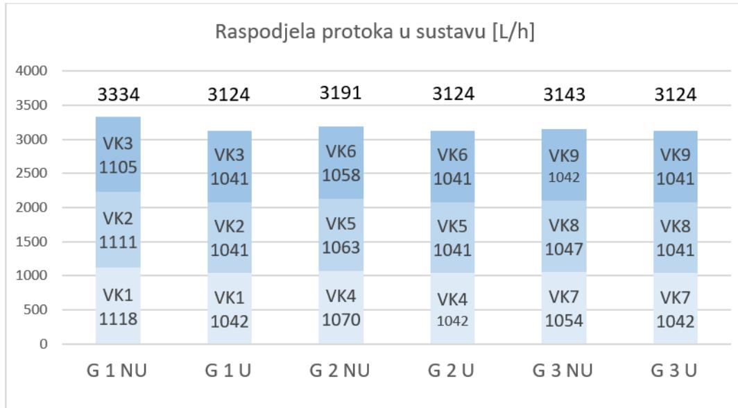
**Slika 6.1. Raspodjela protoka u ventilokonvektorima u projektnom stanju**
