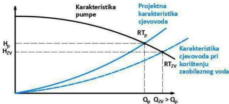
**Slika 3.4. Promjena radne točke kod regulacije zaobilaznim vodom**
