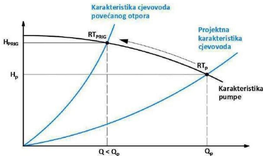
**Slika 3.3. Promjena radne točke kod regulacije prigušivanjem**
