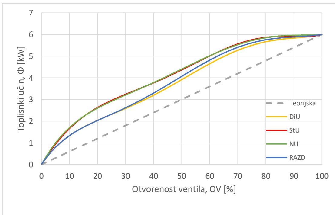
Slika 6.4. Ovisnost toplinskog učina o otvorenosti ventila za ventilkonvektor VK5
