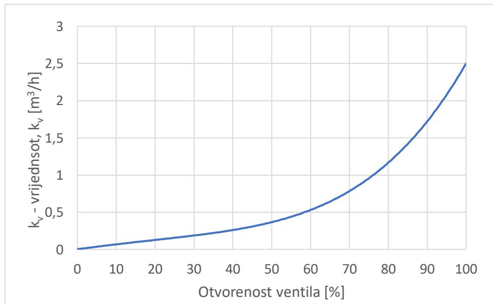
Slika 6.2. Ovisnost  $k_v$  – vrijednosti o otvorenosti ventila
