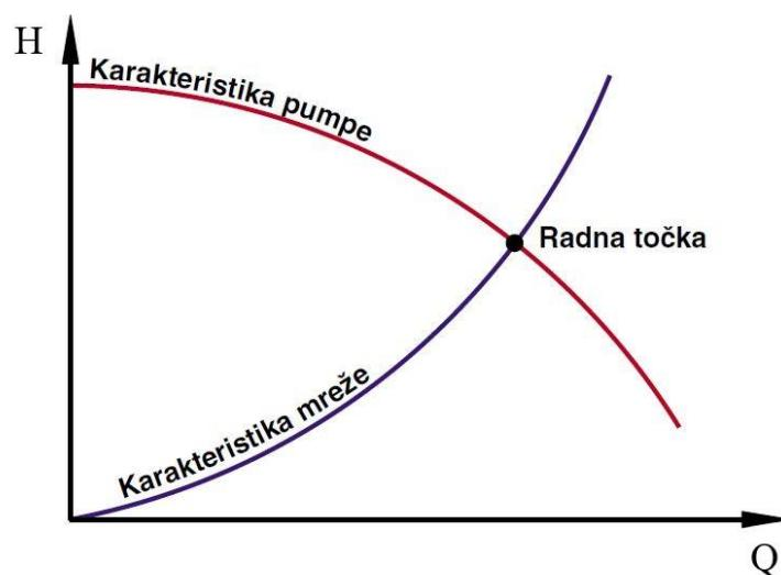
Slika 3.1.  $H, Q$  – dijagram i radna točka pumpe
