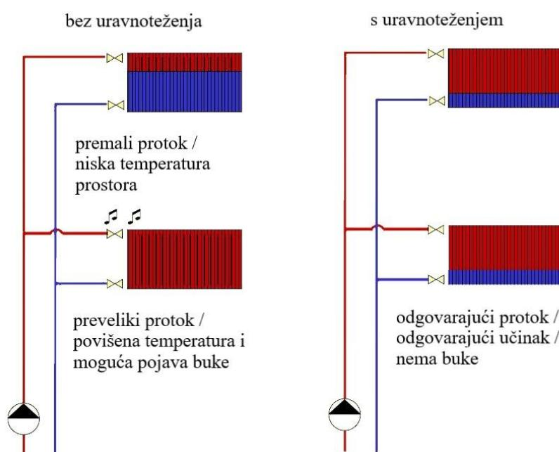
**Slika 1.9. Usporedba hidraulički uravnoteženog i neuravnoteženog sustava**
