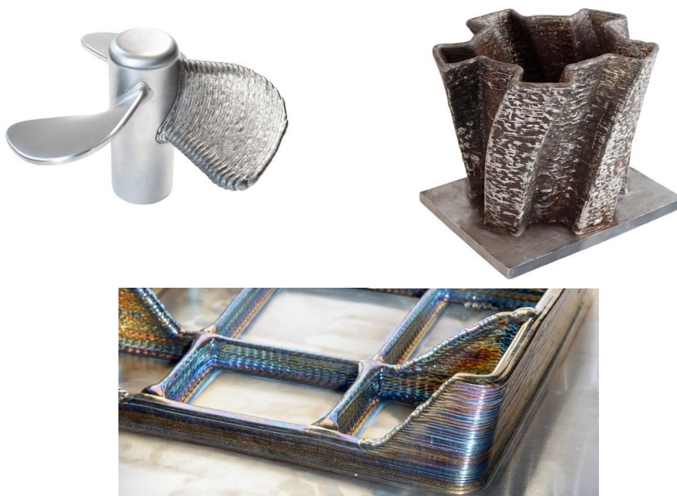
Slika 3.5 Primjeri dijelova izraženih WAAM tehnologijom
