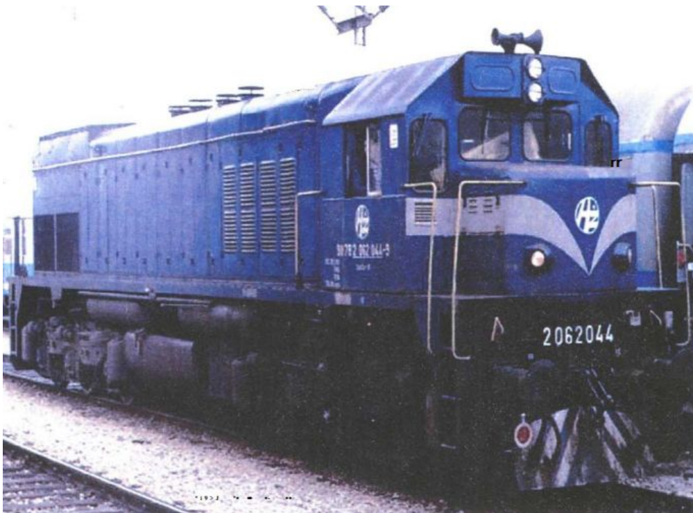
Slika 5. Dizel-električna lokomotiva serije HŽ 2062-000
