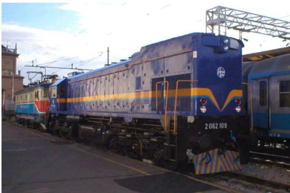
Slika 6. Dizel-električna lokomotiva serije HŽ 2062-100
