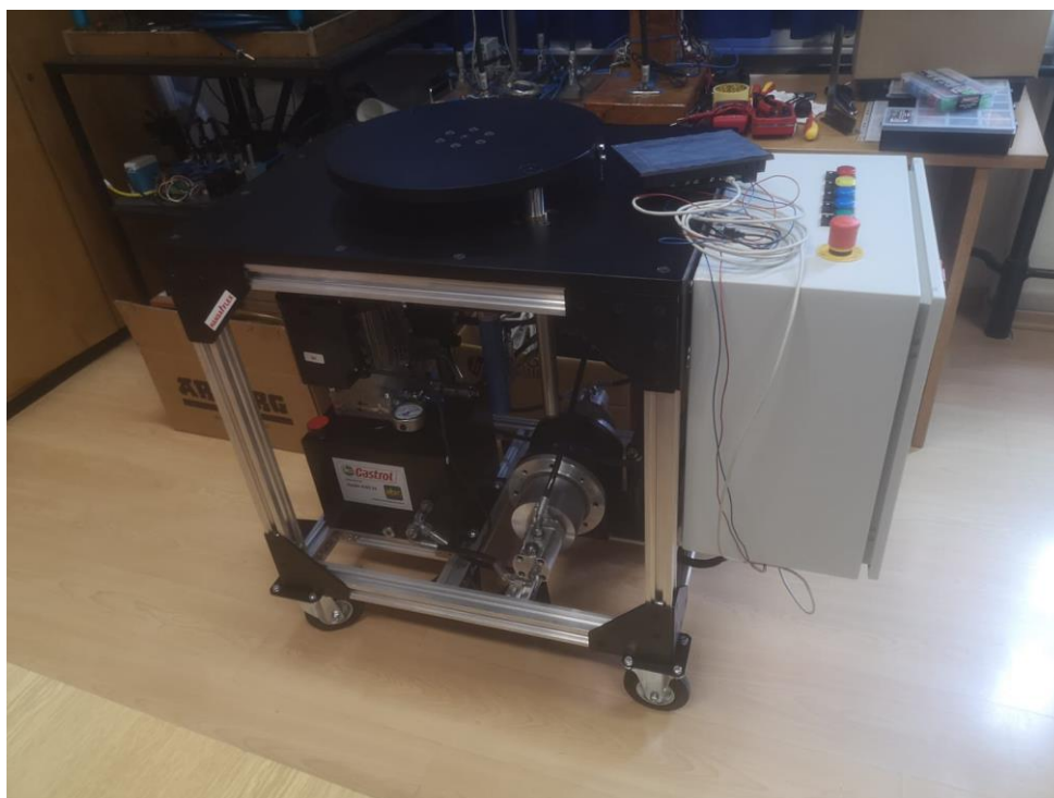
Slika 16. Fotografija postava direktno pogonjenog hidrauličkog sustava
