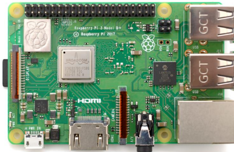
Slika 47 Raspberry Pi 3B+
