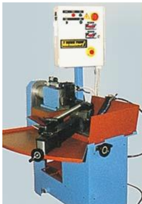
SLIKA 15 – Stroj za glodanje cijevi (MIRA)
