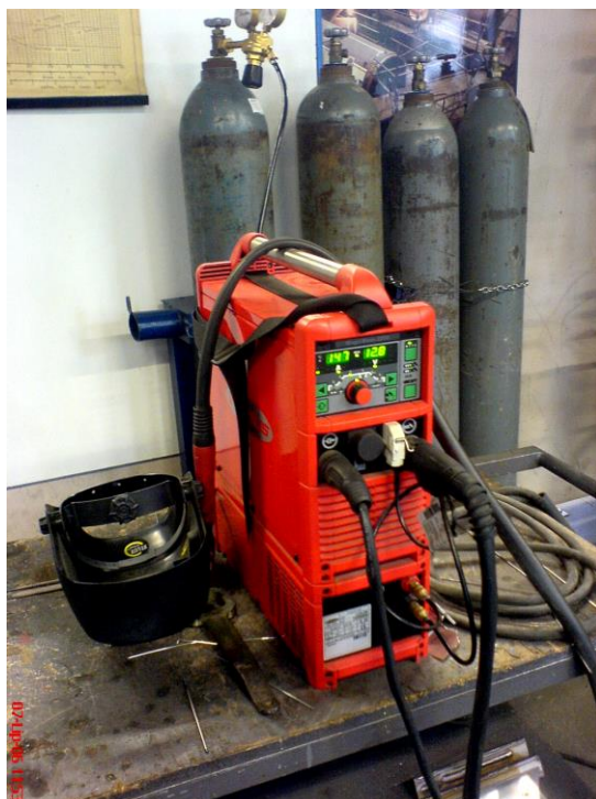
SLIKA 19 – Fronius aparat za TIG zavarivanje
