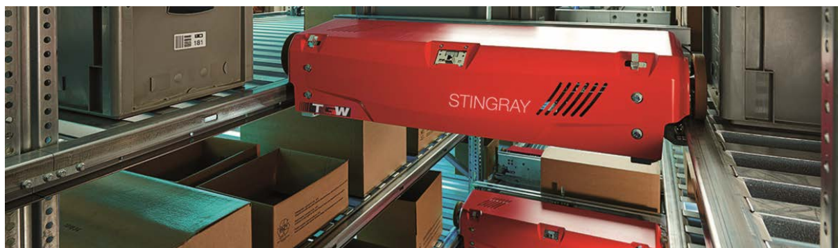
Slika 11. Regalno vozilo Stingray tvrtke TGW [12]
