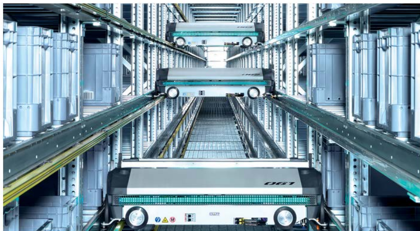
Slika 12. SBS/RS tvrtke Knapp [13]
