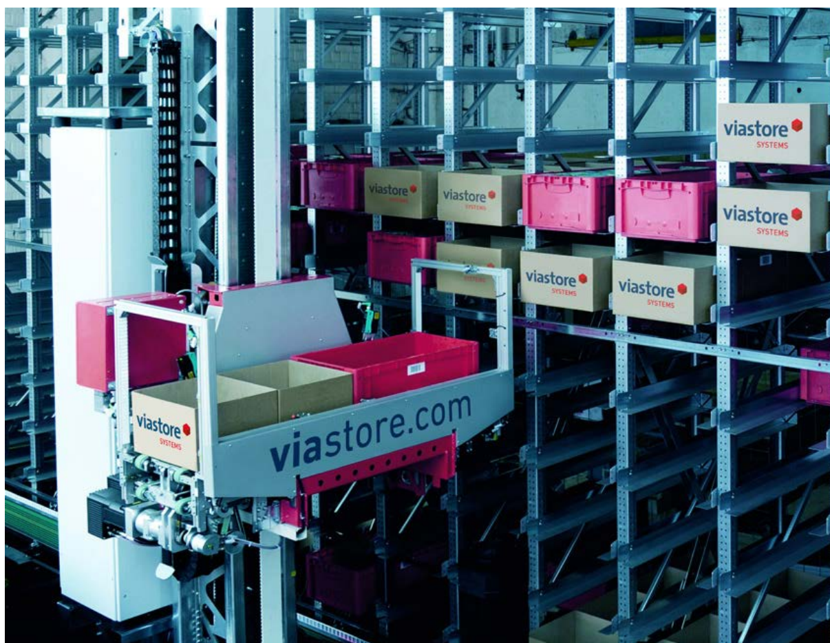
Slika 10. Lift za transport više kutija istovremeno [11]
