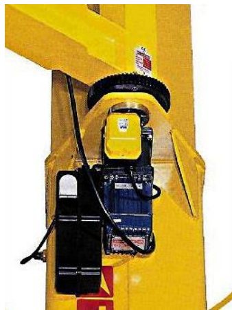
Slika 8. Rotacija granika elektromotorom i zupčastim prijenosom
