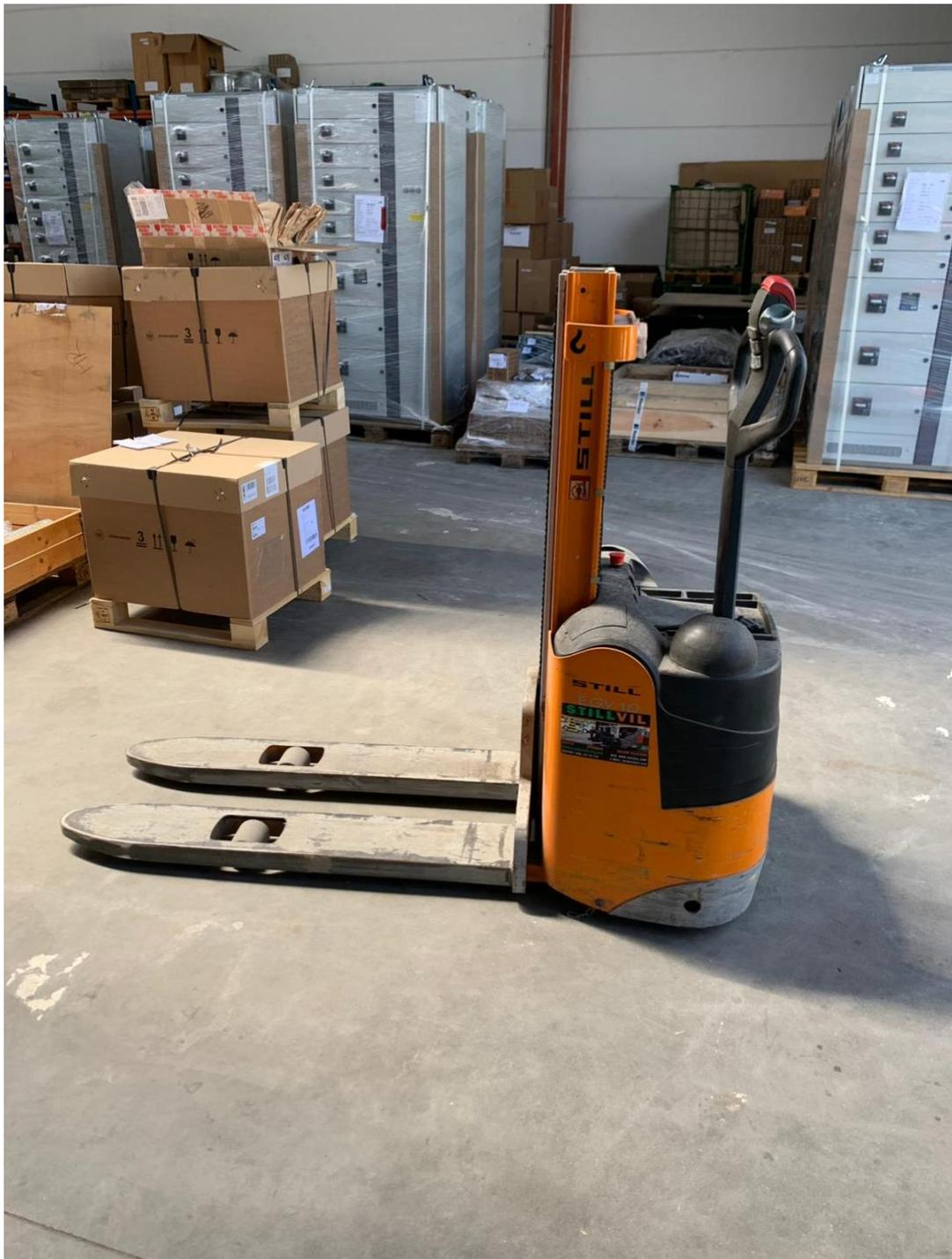
Slika 28 – Električni visokopodizni viličar
