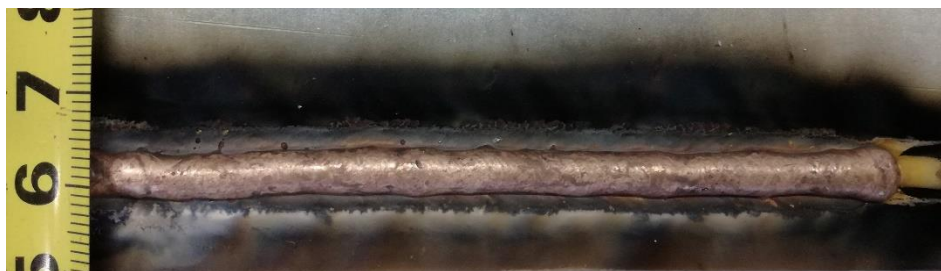
Slika 38. Izgled navara postignutog kombiniranim CMT postupkom
