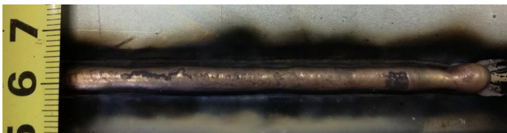
Slika 36. Izgled navara postignutog impulsnim CMT postupkom
