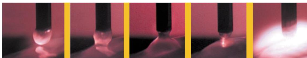
Slika 9. Slijed odvajanja kapljice pri STT zavarivanju [3]
