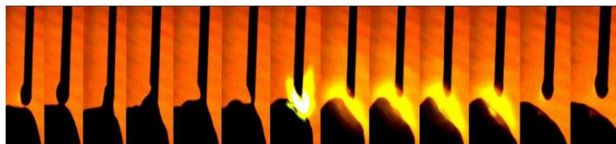
Slika 11. Slijed odvajanja kapljice pri FastROOT zavarivanju [3]
