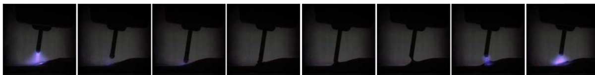
Slika 13. Slijed odvajanja kapljice kod CMT postupka [3]
