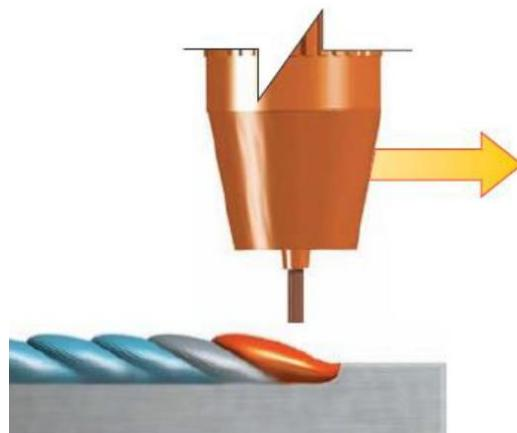
Slika 28. Položaj pištolja kod zavarivanja uzorka – neutralna tehnika [2]
