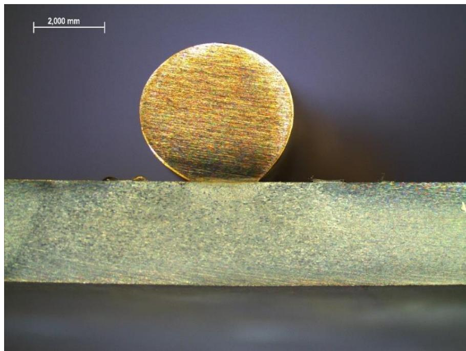
**Slika 30. Makroizbrusak 1. snimljen stereoskopiskim mikroskopom – prijenos metala čistim CMT postupkom**
