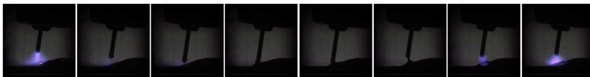
Slika 13. Slijed odvajanja kapljice kod CMT postupka [3]
