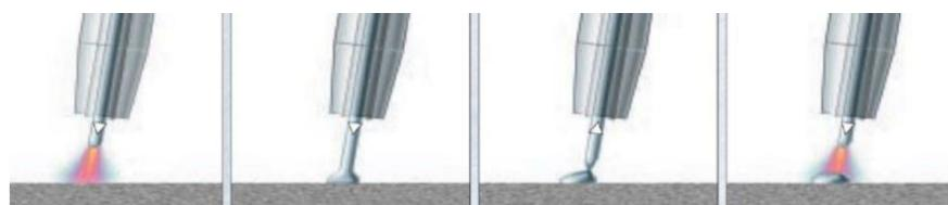
Slika 12. Shematski prikaz povratnog gibanja žice (treći kadar) [3]
