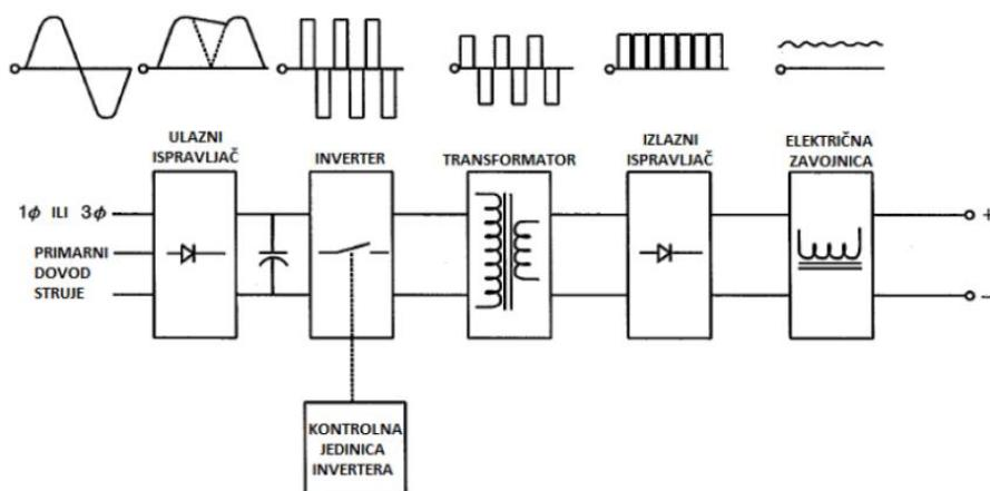
Slika 21. Blok dijagram inverterskog izvora struje [3]
