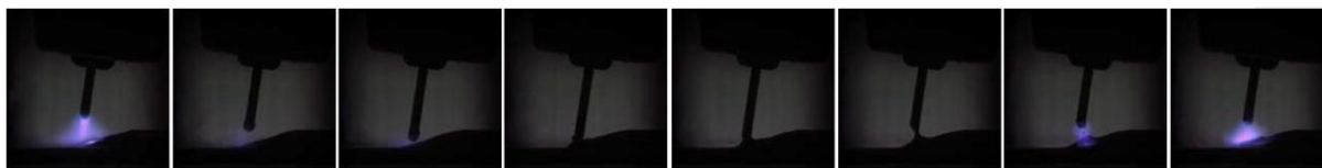
Slika 13. Slijed odvajanja kapljice kod CMT postupka [3]
