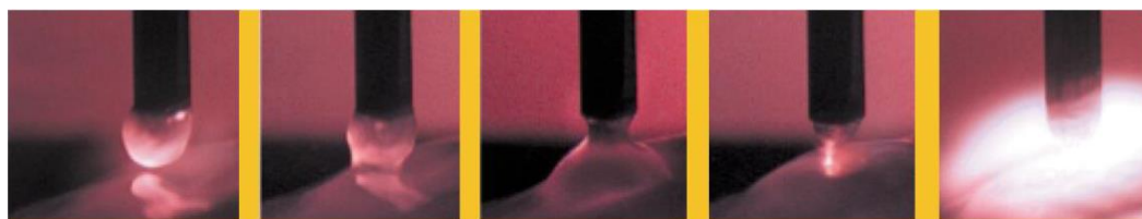
Slika 9. Slijed odvajanja kapljice pri STT zavarivanju [3]
