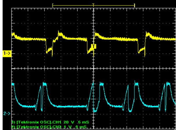
Slika 8. Dinamička karakteristika: 1)  $u = f(t)$ ; 2)  $i = f(t)$  STT postupka [3]
