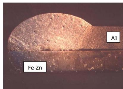
**Slika 14.** Makroizbrusak spoja aluminijskog i pocićanog lima izvedenog CMT postupkom [3]
