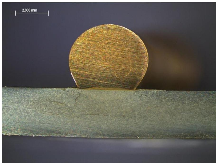
**Slika 31. Makroizbrusak 2. snimljen stereoskopiskim mikroskopom – prijenos metala impulsnim CMT postupkom**
