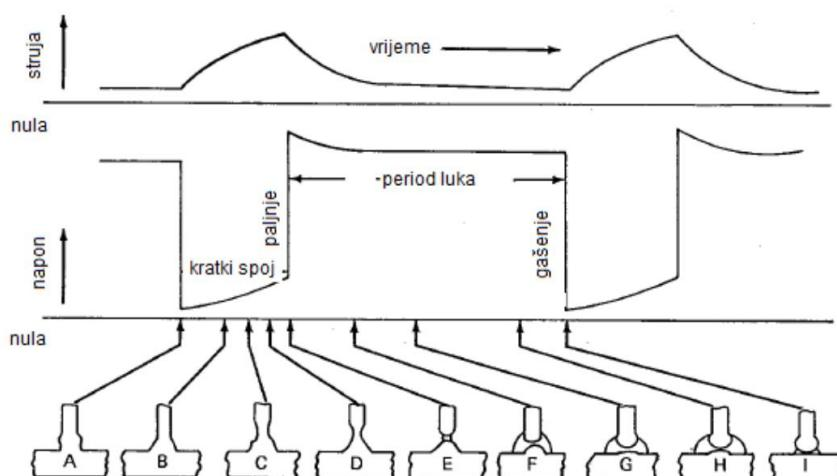
**Slika 3. Shematski prikaz prijenosa metala kratkim spojevima [5]**
