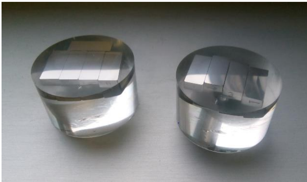
Slika 12. Uzorci u polimernoj masi
