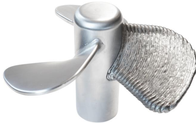
Slika 23. Brodski propeler izrađen WAAM tehnologijom [22]
