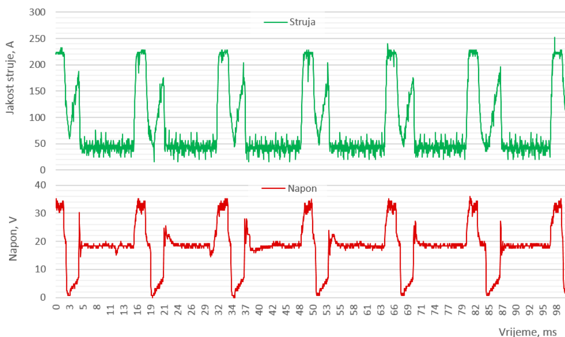
Slika 40. Dinamička karakteristika za prijenos metala impulsnim lukom pri 100 A
